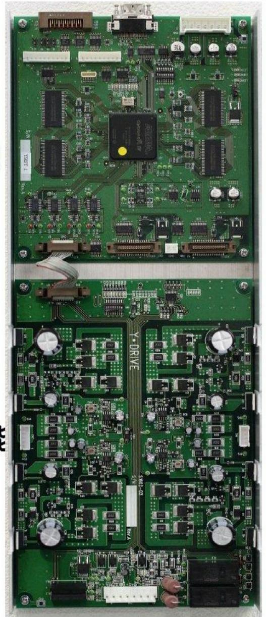
Dimatix用ヘッド駆動制御基板です。 SG/PQ/QS/QEを制御可能です。
