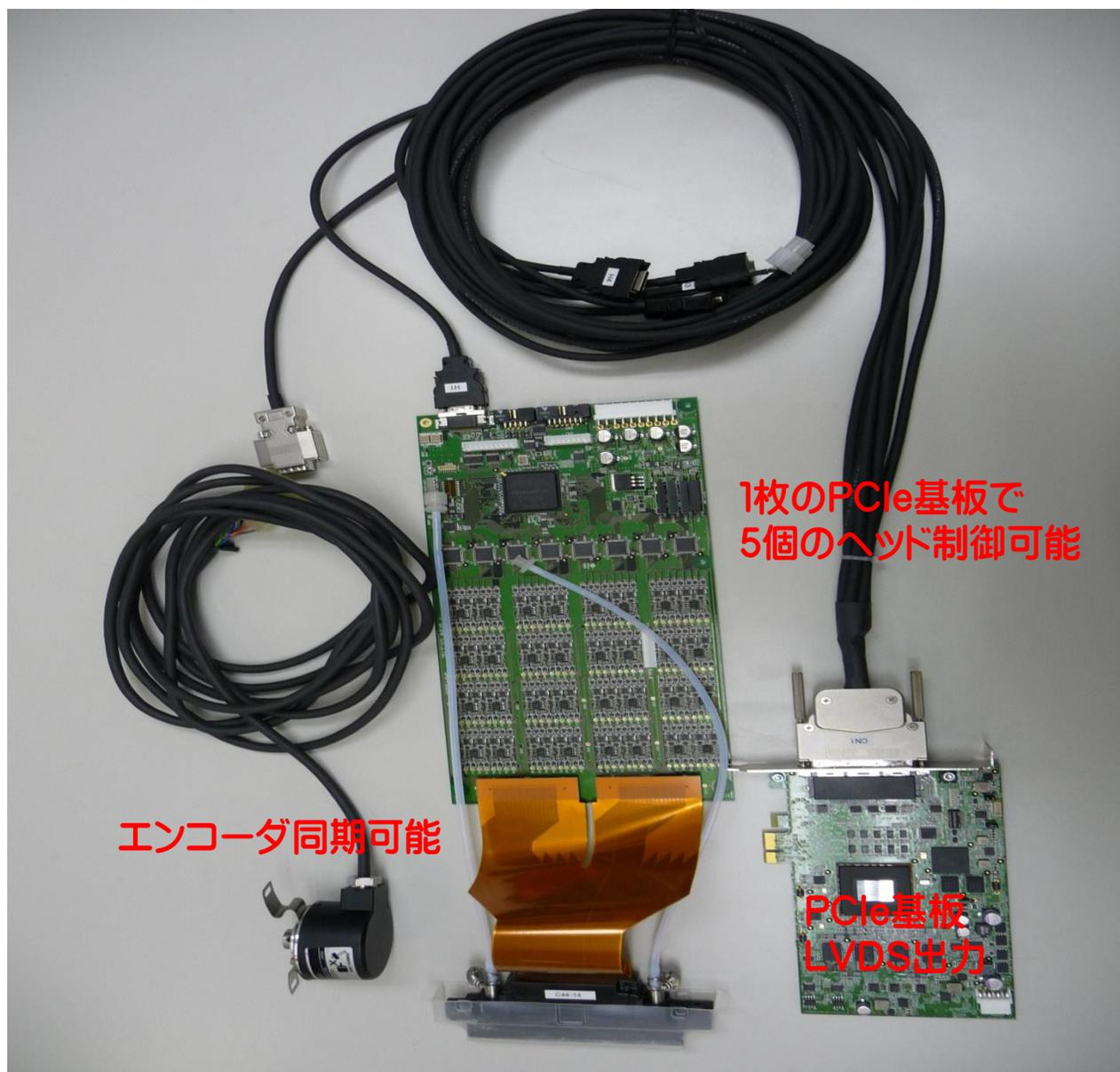
KM256LNB-DPN用ヘッド駆動制御基板です。フルスペックで制御可能です。
