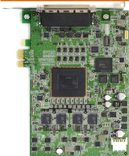
PCIe x1・GEN2 高速DMA転送・350MB/秒
