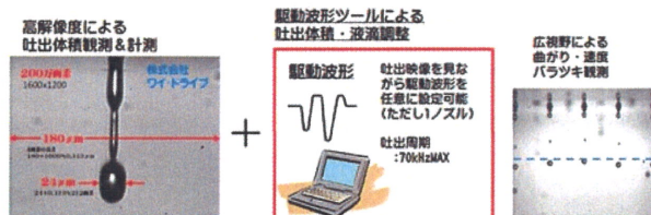
吐出液滴を観測しながら駆動波形を調整し、吐出体積を±1%、インク液滴を1滴にサテライト無しにする。メニスカス挙動を最適化しノズルからの泡噛みを無くする。
